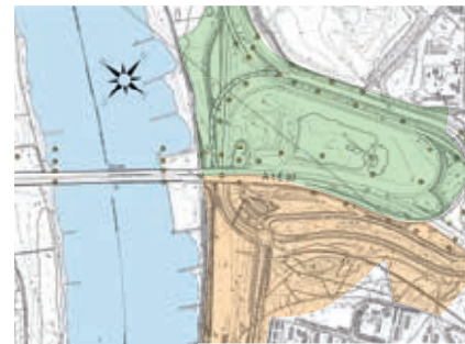
Straßen.NRW wird rund um die Rheinbrücke auf Leverkusener sowie Kölner Gebiet nach und nach zahlreiche Probebohrungen vornehmen lassen. Damit soll die Beschaffenheit und Struktur des Bodens erkundet werden. Denkbare Bohrpunkte sind hier markiert. In einer ersten Erkundung sollen zunächst 17 Bohrungen vorgenommen werden. Erst danach können Ort und Anzahl der weiteren Bohrungen genau bestimmt werden.
