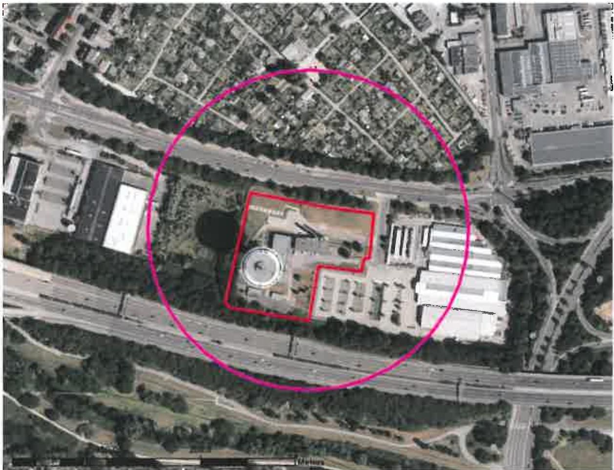
Abbildung 6: Angemessener Abstand nach KAS-18 für den Betriebsbereich (Fa. Energieversorgung Leverkusen GmbH & Co. KG) unter Berücksichtigung der Entwicklungsmöglichkeiten des Betriebsbereiches
