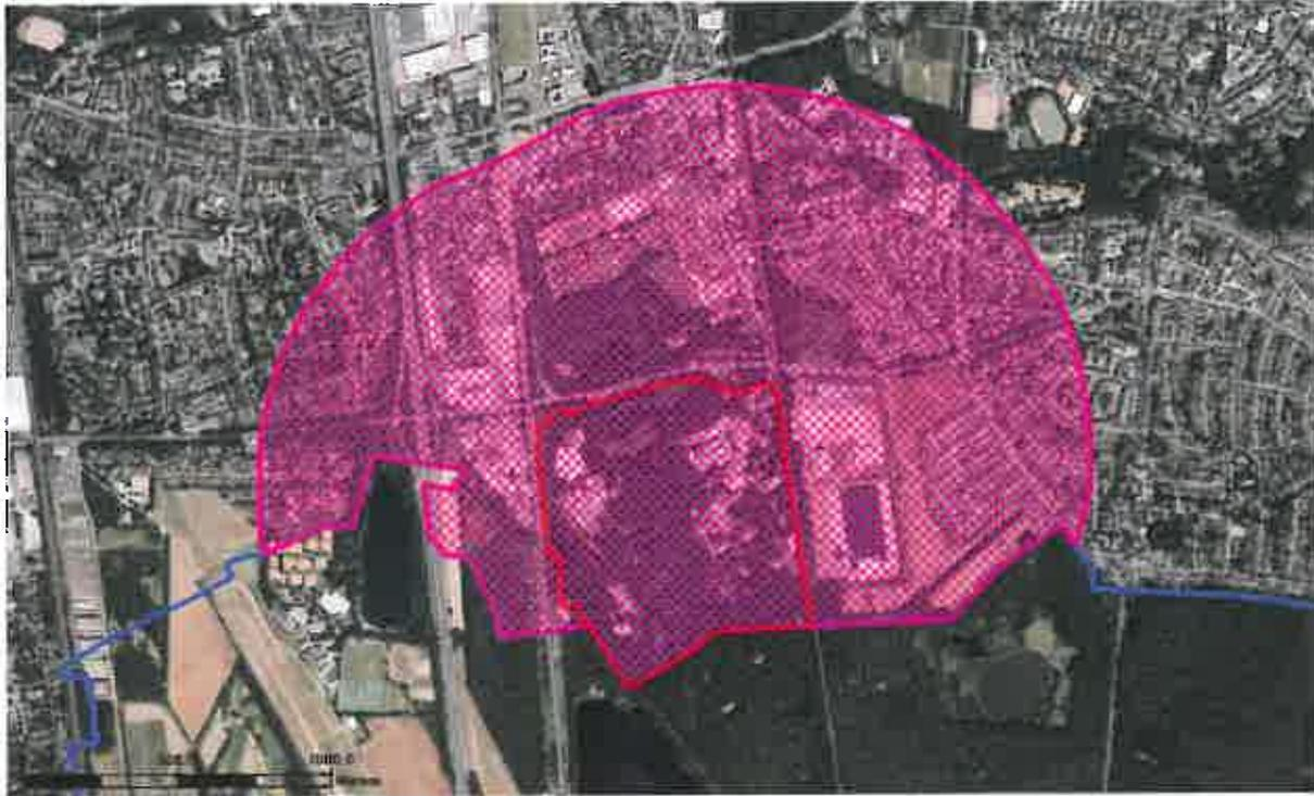
Abbildung 16: Für den Betriebsbereich (Fa. Dynamit Nobel GmbH Explosivstoff- und Systemtechnik, Stadtgebiet Leverkusen) ermittelter angemessener Abstand nach KAS-18
