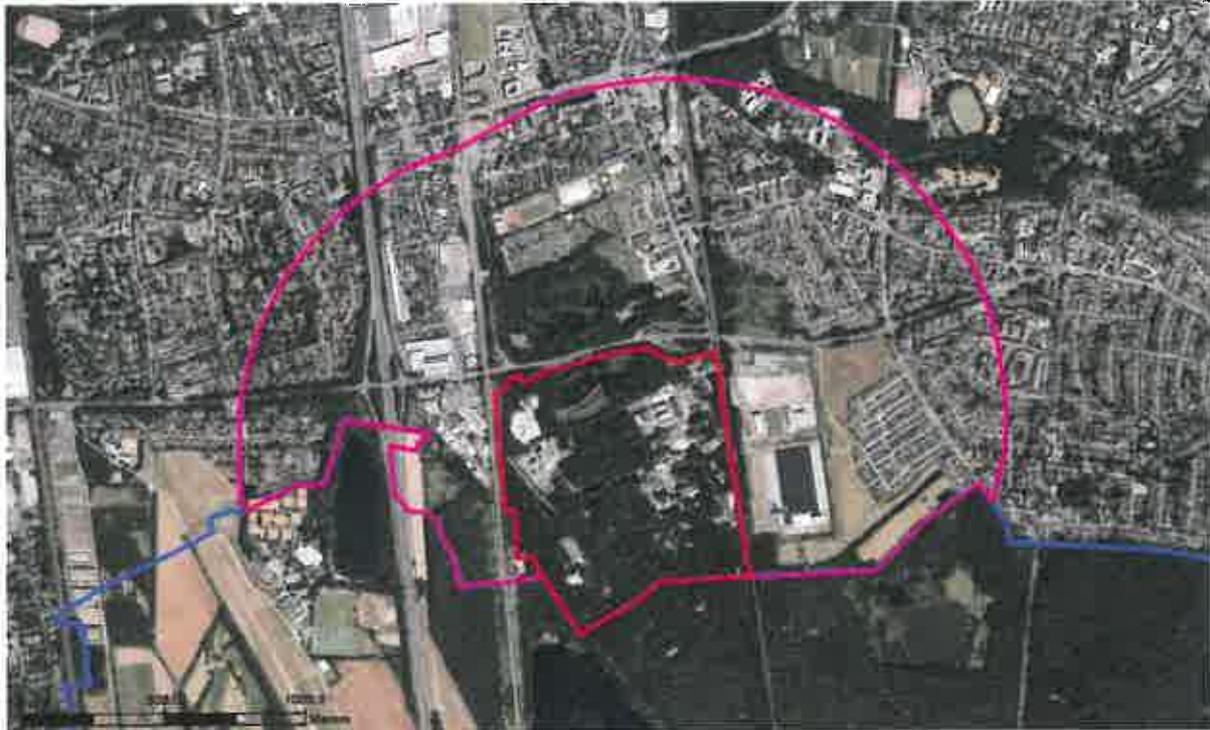
Abbildung 17: Angemessener Abstand nach KAS-18 für den Betriebsbereich (Fa. Dynamit Nobel GmbH Explosivstoff- und Systemtechnik, Stadtgebiet Leverkusen) unter Berücksichtigung der Entwicklungsmöglichkeiten des Betriebsbereiches
