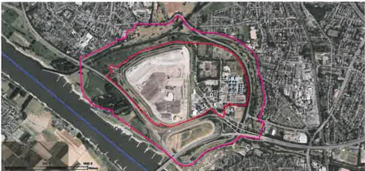
Abbildung 10: Angemessener Abstand nach KAS-18 für den Betriebsbereich (Entsorgungszentrum CHEMPARK) unter Berücksichtigung der Entwicklungsmöglichkeiten des Betriebsbereiches
