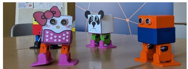
Nach dem Zusammenbau ging es darum, die Roboter mit der Programmiersprache „Blockly“ zu programmieren. Die kleinen Otto DIY Roboter mussten lernen, in welcher Reihenfolge, sie
