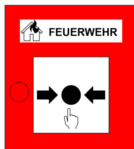
Abbildung: Handfeuermelder mit Aufschaltung zur Feuerwehr
